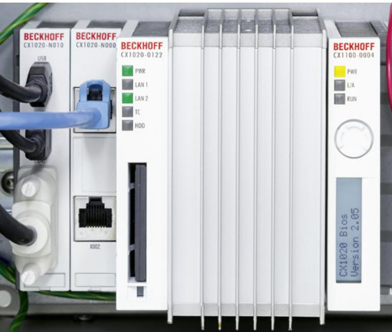
Als Steuerung des Drehmomentprüfgerätes ist ein Embedded-PC CX1020 im Einsatz, der sämtliche für den Qualifizierungsprozess erforderlichen Testfunktionen steuert.
