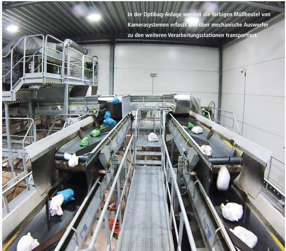
In der Optibag-Anlage werden die farbigen Müllbeutel von Kamerasystemen erfasst und über mechanische Auswerfer zu den weiteren Verarbeitungsstationen transportiert.
