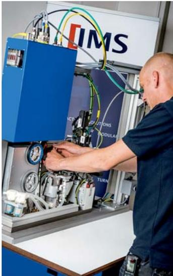
Schaltschrank einer IMS-Produktionslinie mit einem Embedded-PC CX2040, EtherCAT- und TwinSAFE-Klemmen.
