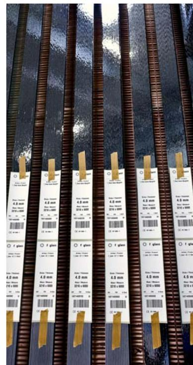
Als letzter Schritt erfolgt die Aufnahme der fertigen Scheiben mit einem Handhabungsroboter auf Transportständer. In einer normalen Schicht wird im Minutentakt eine fertige Glasplatte aus der Anlage entnommen.
