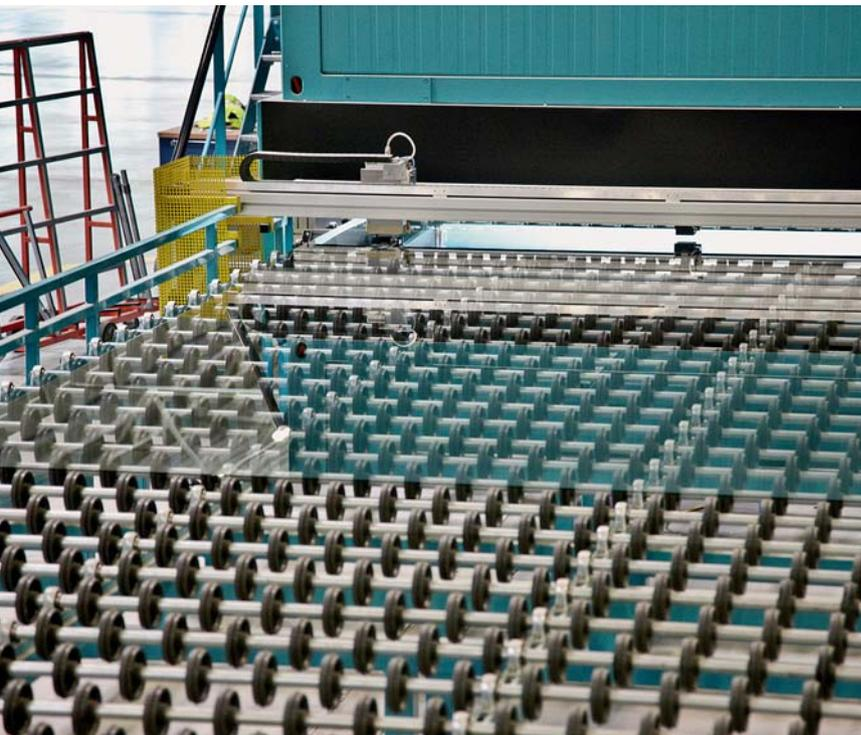
Abschließend erfolgt die Qualitätsprüfung der Beschichtung. Dazu messen optische Sensoren die Lichtreflexion und die Transmission der Scheibe; zudem erfolgt noch eine elektrische Widerstandsmessung.
